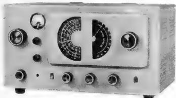
Ein preiswerter Allwellen-9-Kreis-Empfänger von kommerziellem Aussehen und mit den technischen Eigenschaften eines guten Mittelwellen-Kurzwellen-Supers: Hohe Empfindlichkeit, S-Meter, Störbegrenzer, Telegrafie-Überlagerer, Sendempfangsschalter, Kopfhörer- und Lautsprecheranschluß.
