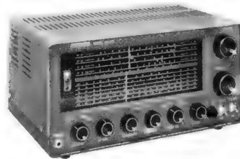
Ein hochwertiger Allwellen-9-Kreis-Empfänger von kommerziellem Aussehen und mit folgenden Eigenschaften: Hohe Empfindlichkeit, S-Meter, Störbegrenzer, veränderliche Bandbreite, Telegrafie-Überlagerer, Sendempfangsschalter, Kopfhörer- und Lautsprecher-Anschluß.
